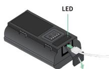
Schließen Sie den Akku an das USB-Kabel an. Der Akku ist vollständig geladen, wenn die LED grün leuchtet
